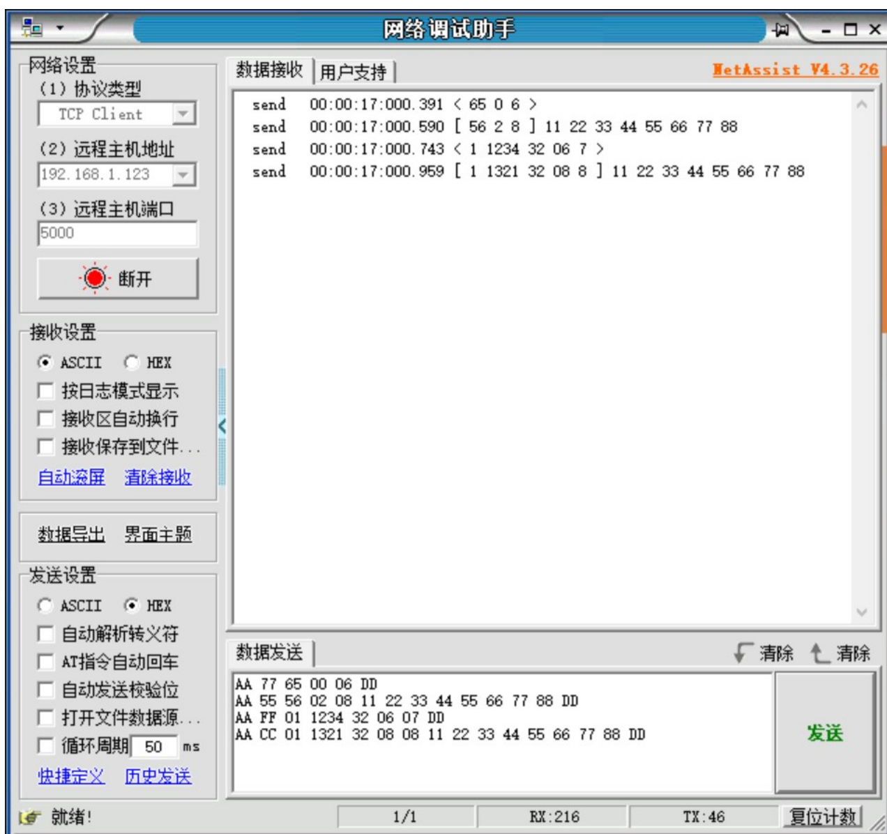
图 15 TTCANopen 调试模块发送指令和回显示例
