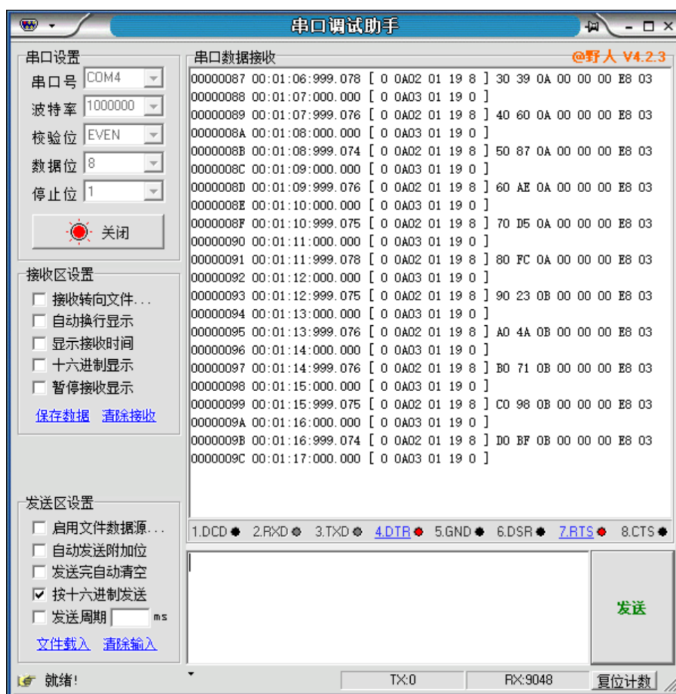
图 14 TTCANopen 调试模块与系统时间同步
